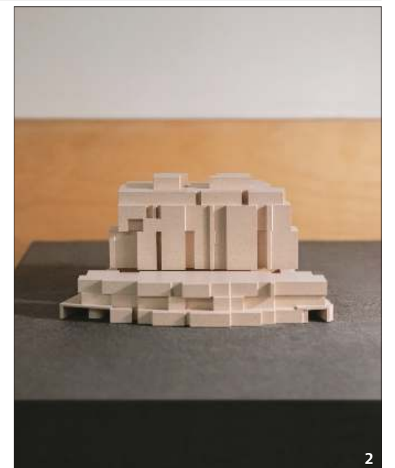
1 라브르 27 렌더링 이미지와 도면이 놓인 BP아키텍츠 사무실 전경. 렌더링 이미지에서 도심 한복판이지만 단독주택 같은 여유가 느껴진다. 2 라브르 27 모형. 3층 규모의 가든하우스가 아래에 있고, 살짝 물러나 7층 규모 건물이 서 있다. 3 라브르 27 단면도. 지하층 로비까지 빠짐없이 채광이 닿도록 설계했다. 도면은 BP아키텍츠 제공.
